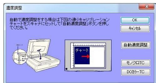
ComicScanは、オートキャリブレーション(濃度調整)を備えています。定期的にこの機能を使いキャリブレーションを行うことにより、消耗品であるランプの明るさの変化にかかわらず一定の濃度品質を実現できます。また、キャリブレーションはCCDの感度曲線を補正し、リニアカーブを確保することができます。これを基にトーンカーブで自由な調子を実現できます。
